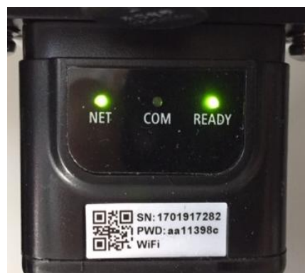
Abbildung 71 - Unregelmäßiger Kommunikationsstatus zwischen Inverter und Platine
