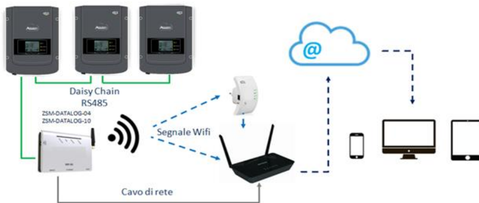
Abbildung 73 – Verbindungsschema des Datenloggers ZSM-DATALOG-04 / ZSM-DATALOG-10
