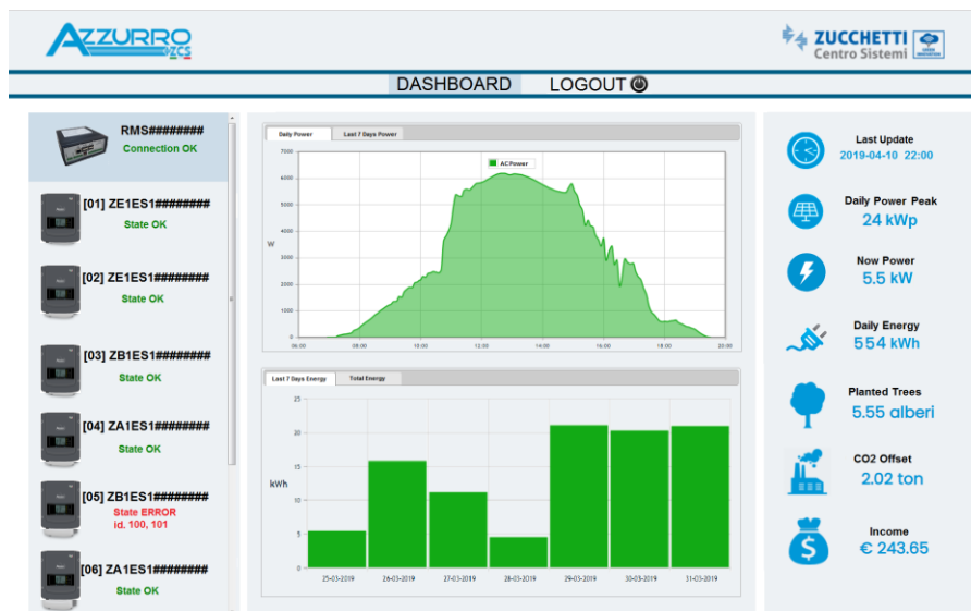
Abbildung 99 - Beispiel einer Seite der lokalen Überwachung
