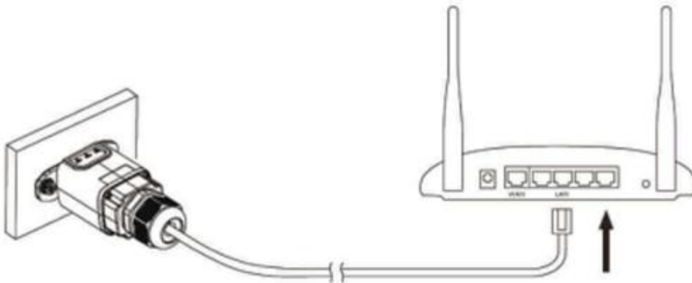
Abbildung 62- Anschließen des Netzkabels an das Modem
