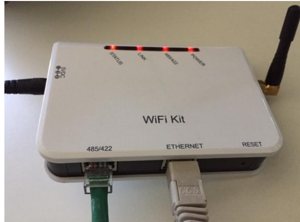
Abbildung 81 – An den Datenlogger angeschlossenes Ethernet-Kabel
