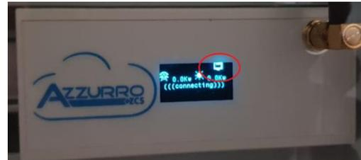
Abbildung 47 - Connext über GSM (links) oder über LAN (rechts)
